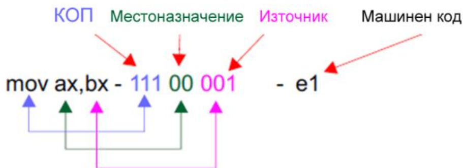
Фиг.3 Пример за кодиране на инструкция тип регистър-регистър от кодовия набор инструкции на xCPU.
