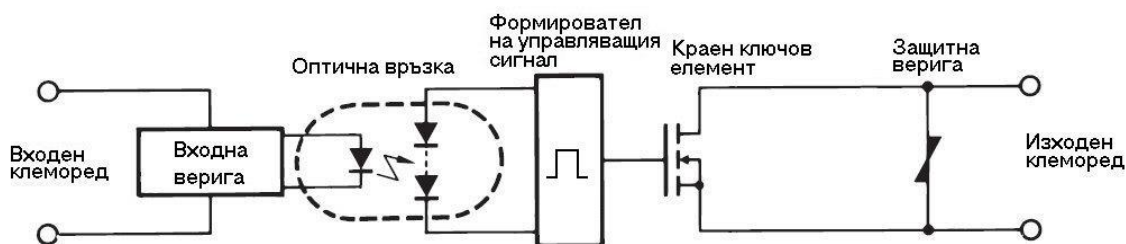
Фиг.2 Функционална схема на SSR.
