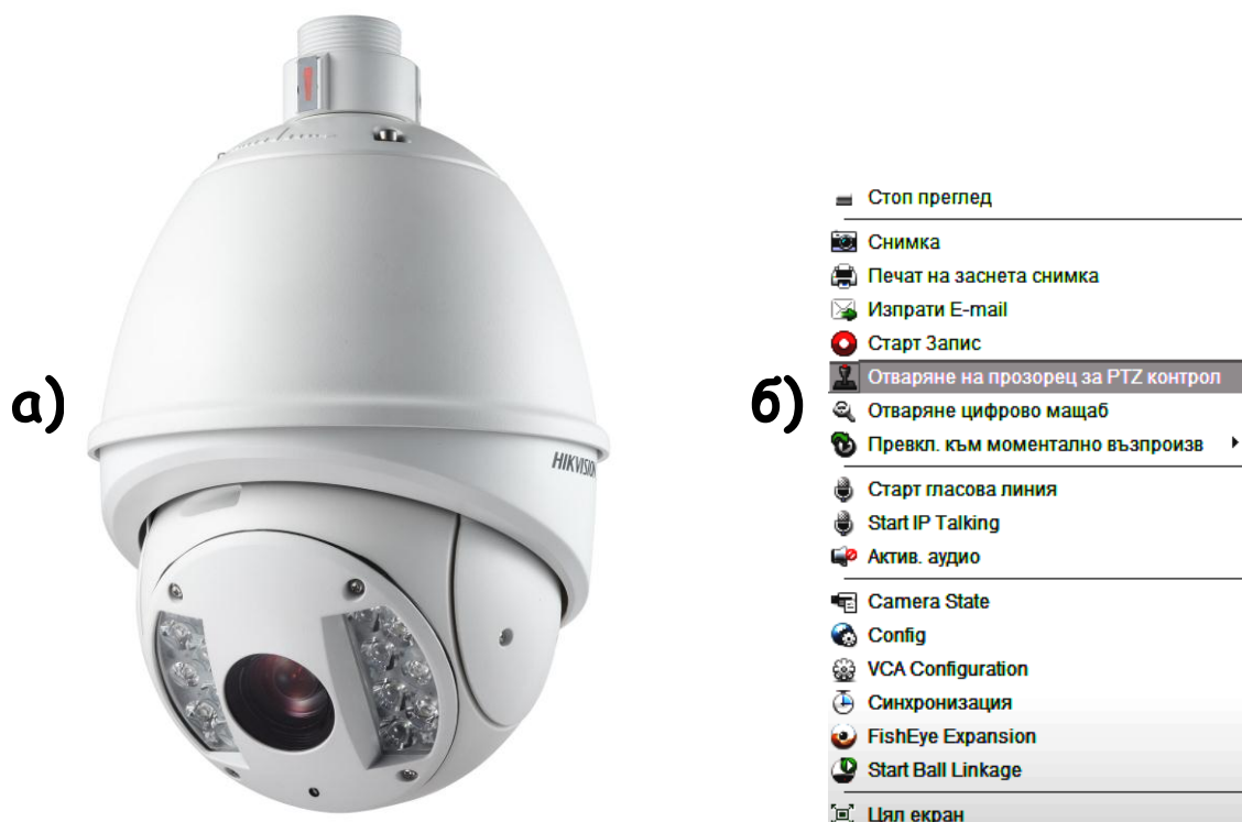
Фиг. 7: Камера с PTZ контрол: а) общ вид; б) вземане на инструментите за PTZ контрол
