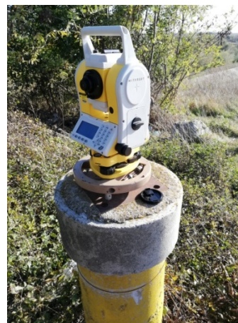
Фиг. 2 - б). Използване на пиростия за центриране
