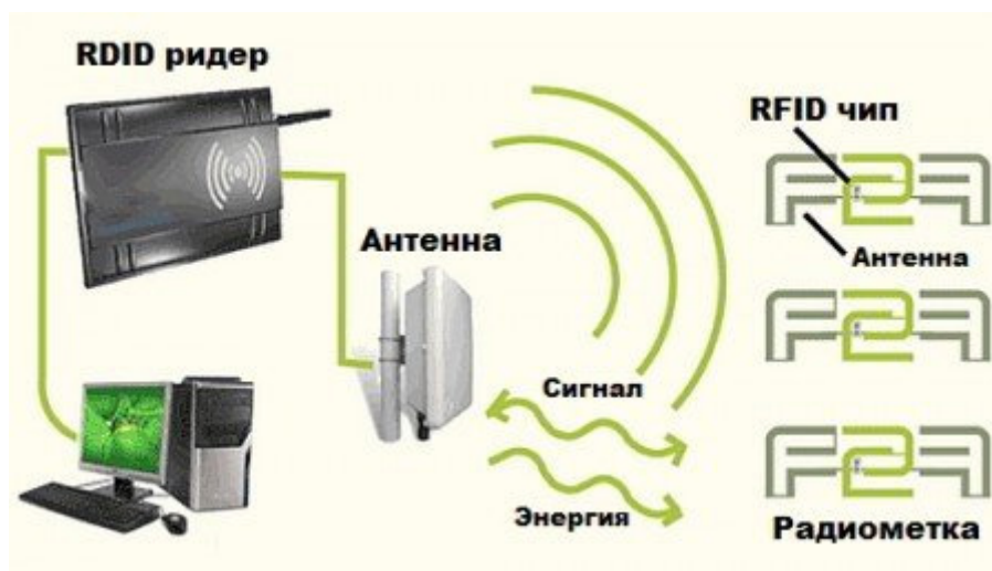
Фиг. 2. Примерна локална RFID система
