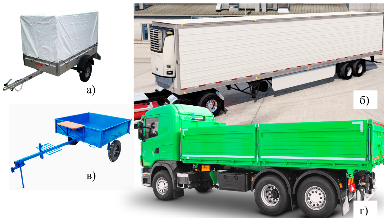
Фиг. 2. Превозни средства с товарно пространство от вида цял правоъгълен паралелепипед: а) ремарке за лек автомобил; б) дълго хладилно полуремарке за седлови влекач; в) ремарке за мотоблок; г) товарен автомобил
