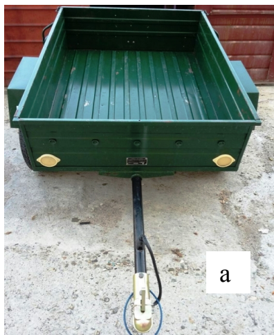
Фиг. 5. Премаиване от един ок (а) към две рамена (б) за теглича при ремаркетата за леки автомобили
