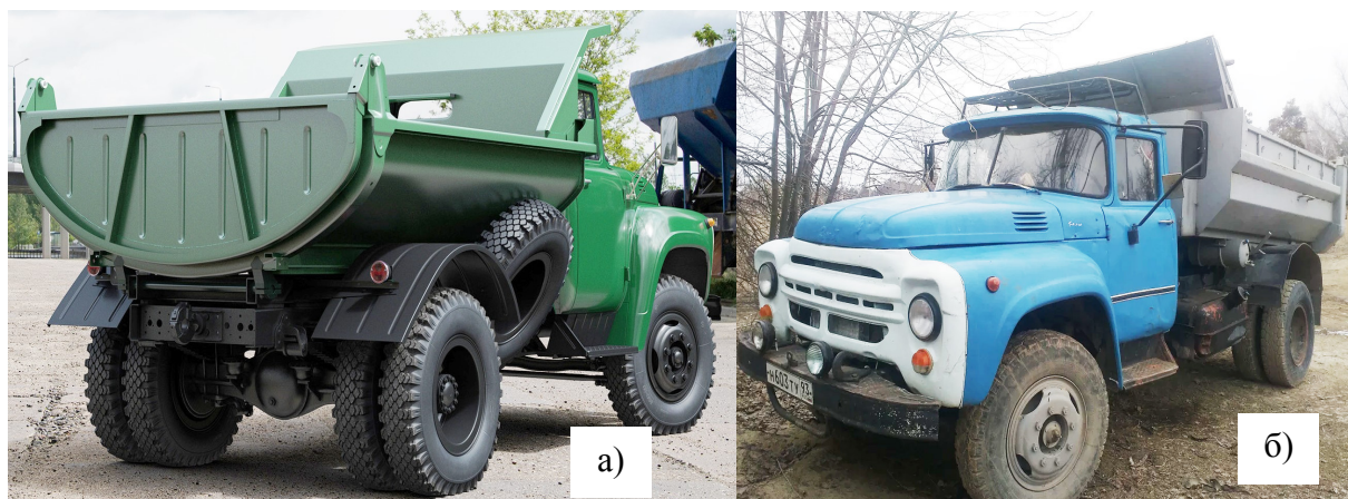
Фиг. 4: Самосвал ЗИЛ-ММЗ-555, подходящ за насипни товари и бетон: а) първи модел със заоблен кош; б) следващият модел кош
