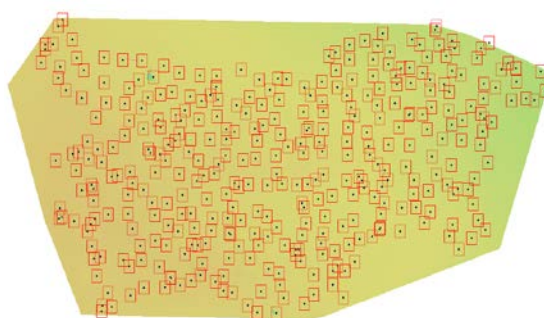
Фиг. 3. 3D ГНСС/нивелация модел на локалния геоид с точките от гравиметричния каталог
