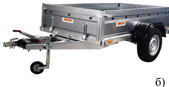
Фиг. 5. Премаиване от един ок (а) към две рамена (б) за теглича при ремаркетата за леки автомобили
