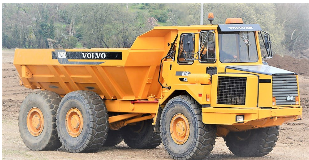
Фиг. 3. Самосвал VOLVO A25C 6X6 със силно изразено свиване към средата на долния край на коша
