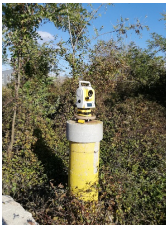
Фиг. 5. Измерване с тотална станция Hi - Target
