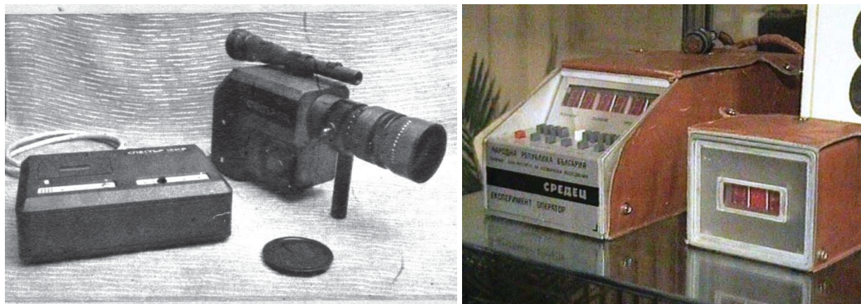
Фиг.2. а) Апаратурите „Спектър-15К” с блока за регистрация на данните в цифров вид на магнитна лента, б) Апаратурата „Средец”
