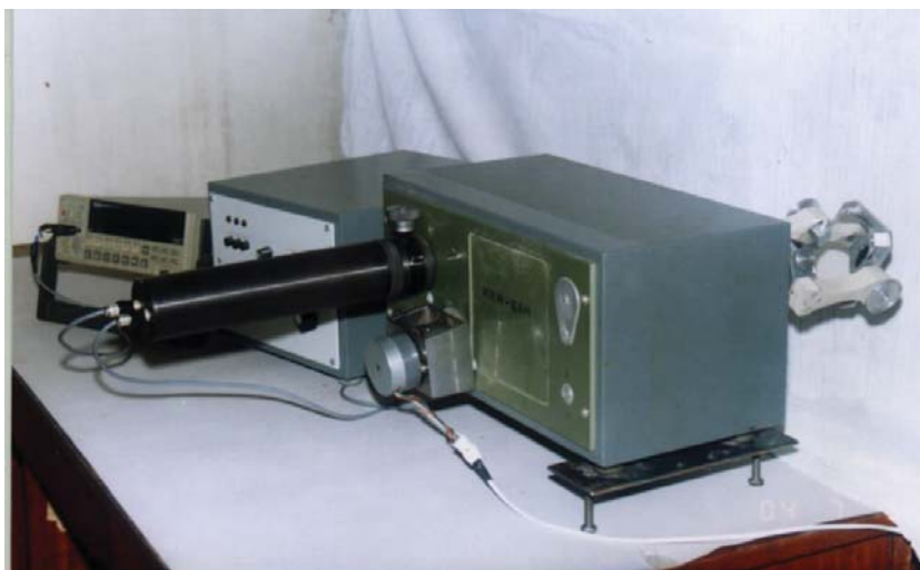
Фиг. 7. Спектрофотометър за изследване на общото съдържание на атмосферния озон
