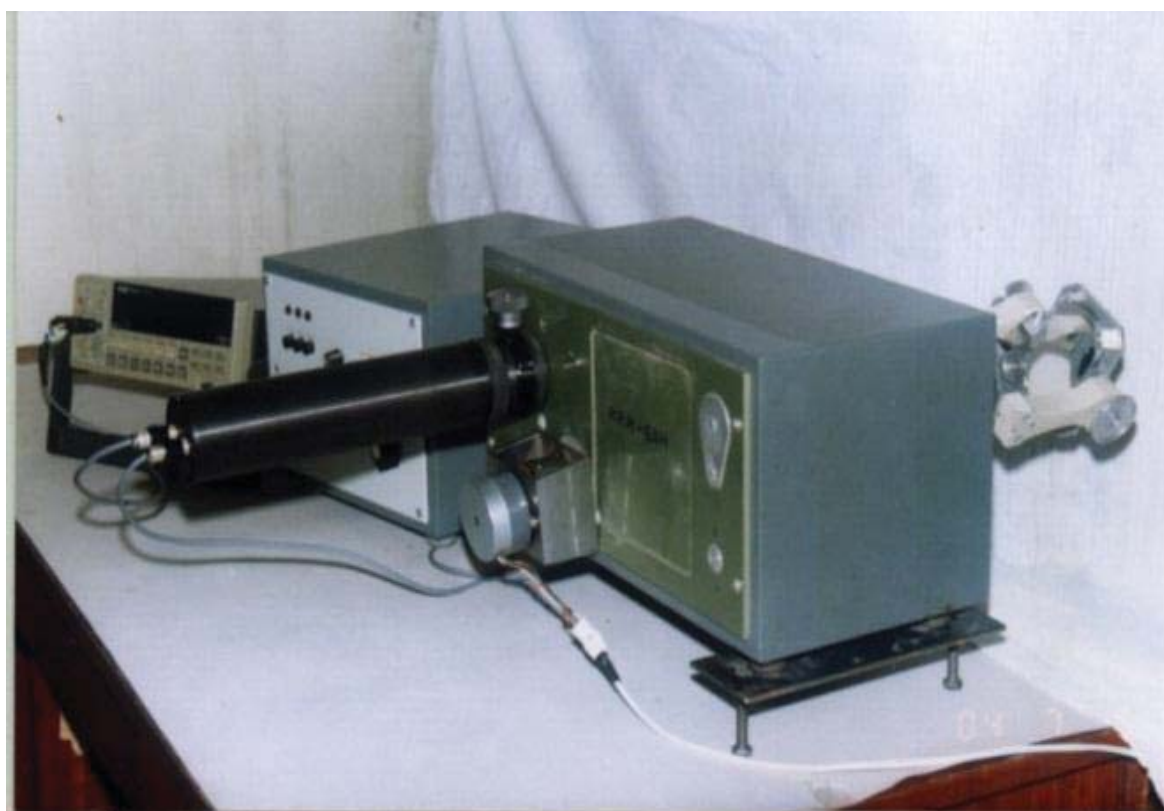
Фиг.11. Спектрофотометър за изследване общото съдържание на атмосферния озон и други малки газове съставлящи на атмосферата
